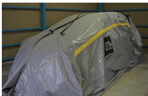
万が一の洪水の時、車をまるごと包み水に浮かせる製品。柔軟性・強度・防水性に優れるPVCターポリン製で、接合部には防水ジッパーを使用しています。また、小さく折りたたんで収納できます。実際にプールで検証したところ、2週間以上、浮き続けたとのこと。
