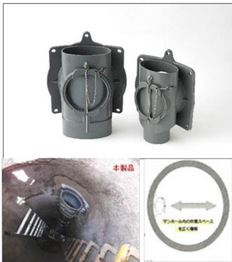
下水道施設計画・設計指針の改定（2019年）に伴い、マンホールの内側に内副管の敷設が必要になりました。しかし、マンホールに数個の配管を付設するとマンホール内での作業性が低下する難点がありました。本製品は流路を楕円型にすることで約30%の小型化を達成し、マンホール内の作業スペースの確保を可能にしました。また、施工性と管内の閉塞対応も考慮されています。
