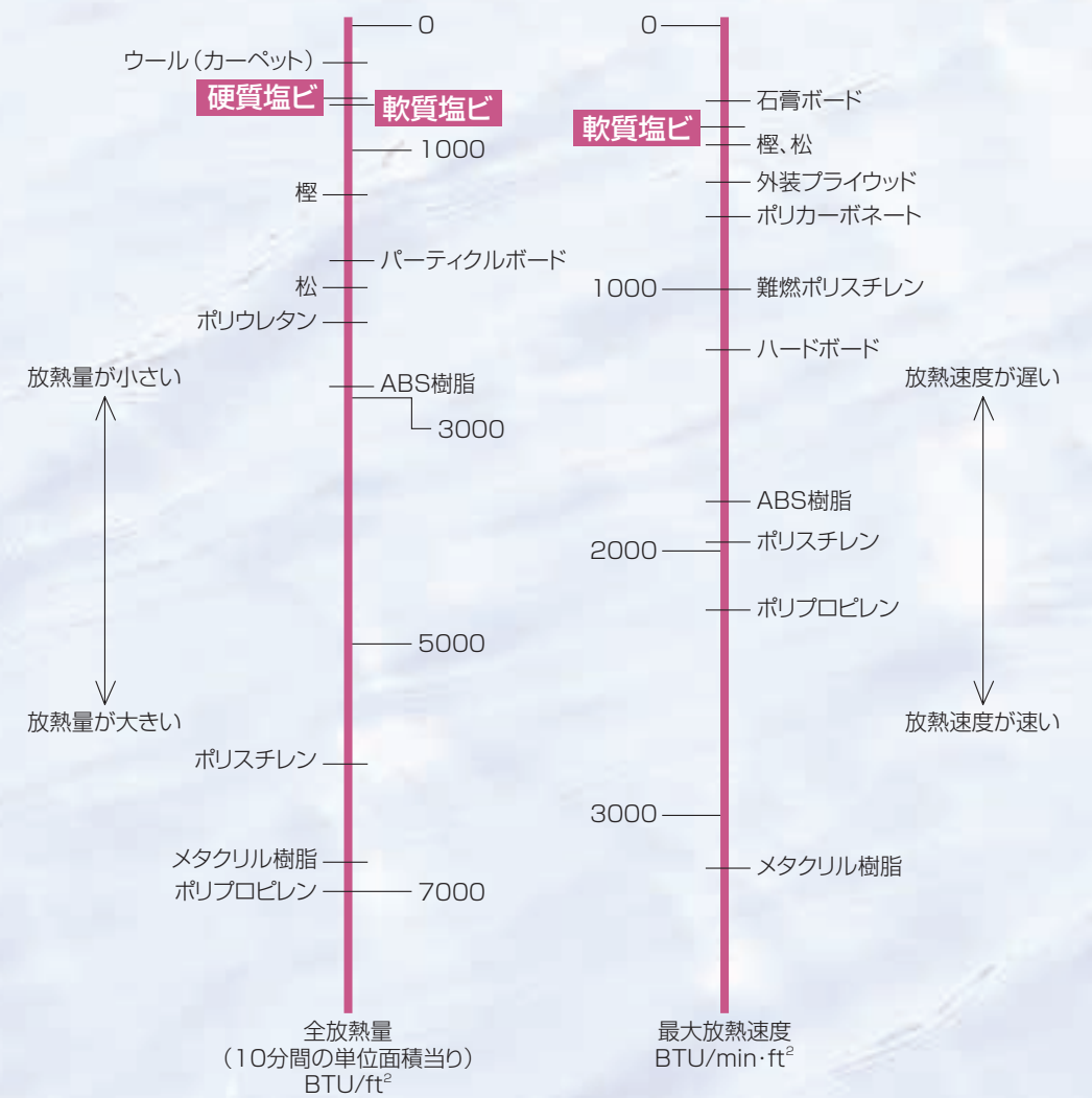
図1-4 各種材料の放熱量と放熱速度 5)
